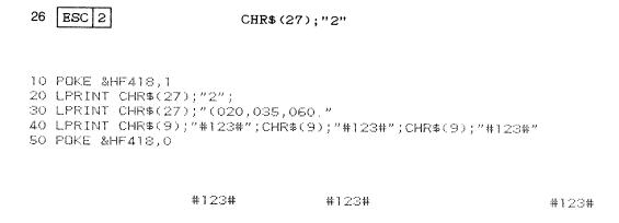
The maximum number of tabs that can be set is 32. Le nombre maximal de tabulateurs que l'on peut sélectionner est de 32.
