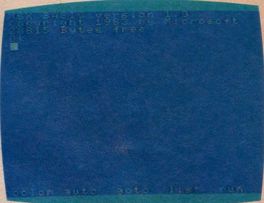
◆F1を押すとBASICモードになり、プログラムを入力できる。
