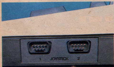
↑本体右側のジョイスティックスロット。2個接続可能。
