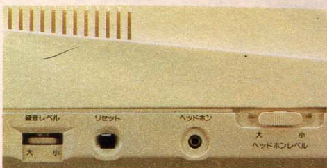
▶MSXでは珍しい、ヘッドホン出力端子を内蔵している。
