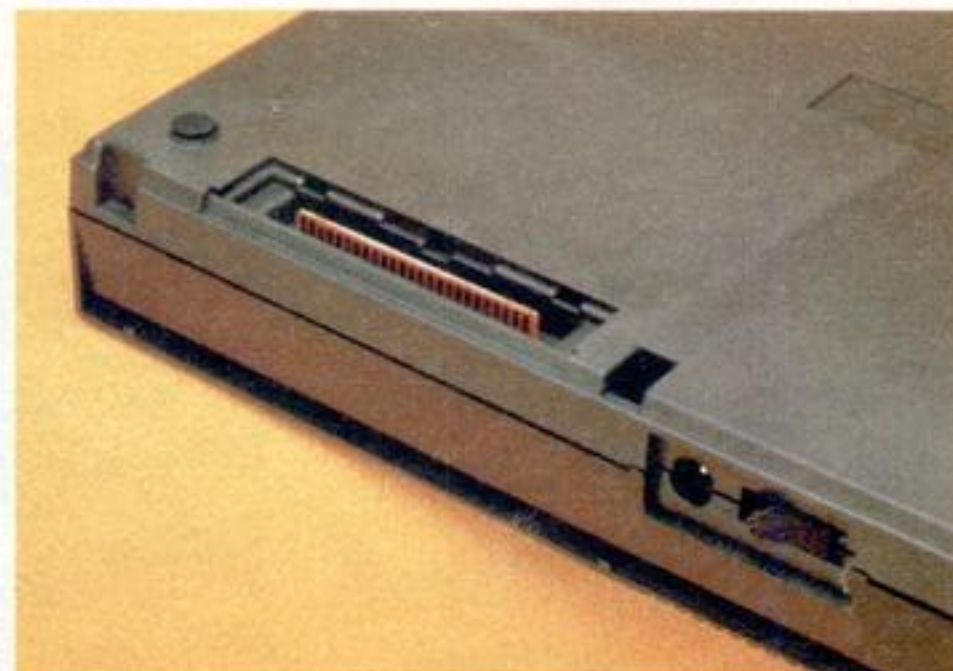
◆本体底面の拡張コネクタ。スロットの裏側に位置し、拡張ボックスとの接続に利用する。使わないときはフタがつく親切設計だ。
