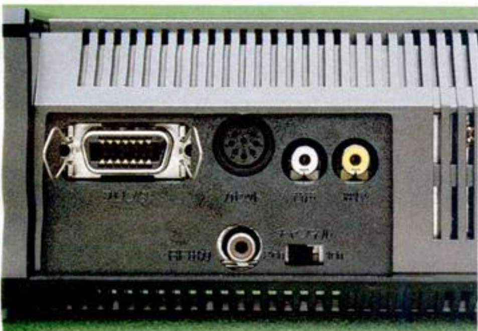
●後面中央に設置された接続端子。何度も抜き差しするものではないので、1カ所に集中させるのもひとつのアイデアだろう。
