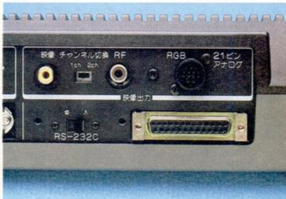
◆下にある平たいコネクタが、RS-232Cインターフェイス。映像出力はRFからRGB21ピンまで、すべてに対応してます。
