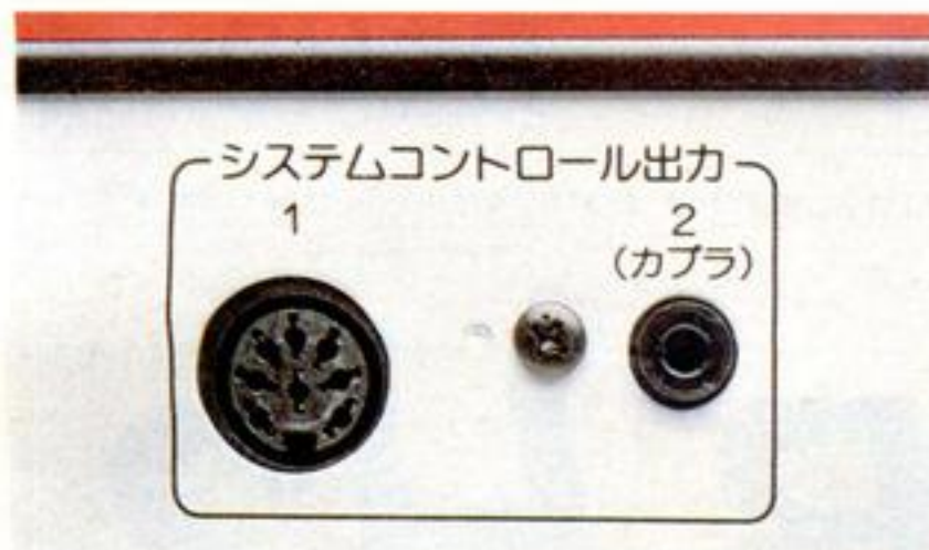
▶レーザーディスクをコントロールするための、システムコントロール出力端子。LD-7000などとつなげます。
