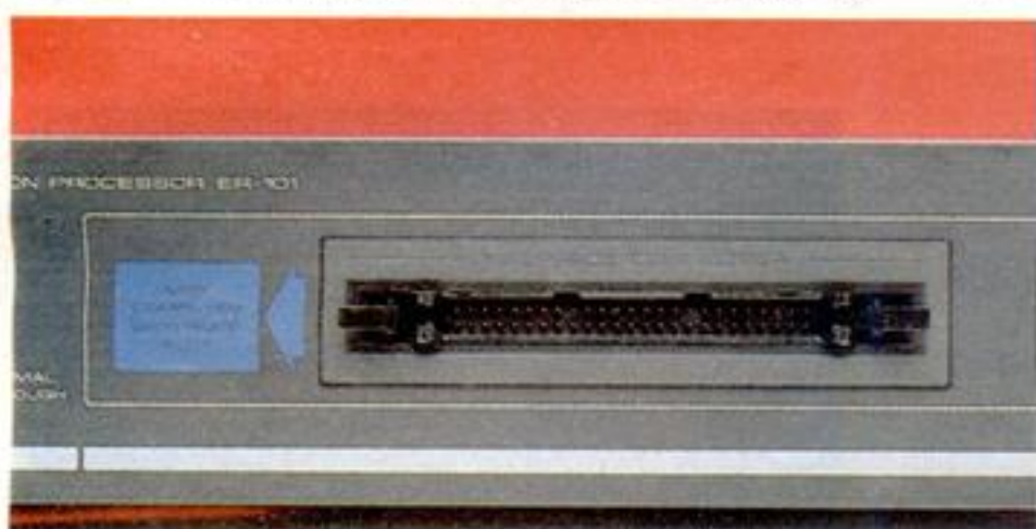
▶レーザーディスクをコントロールするための、システムコントロール出力端子。LD-7000などとつなげます。
