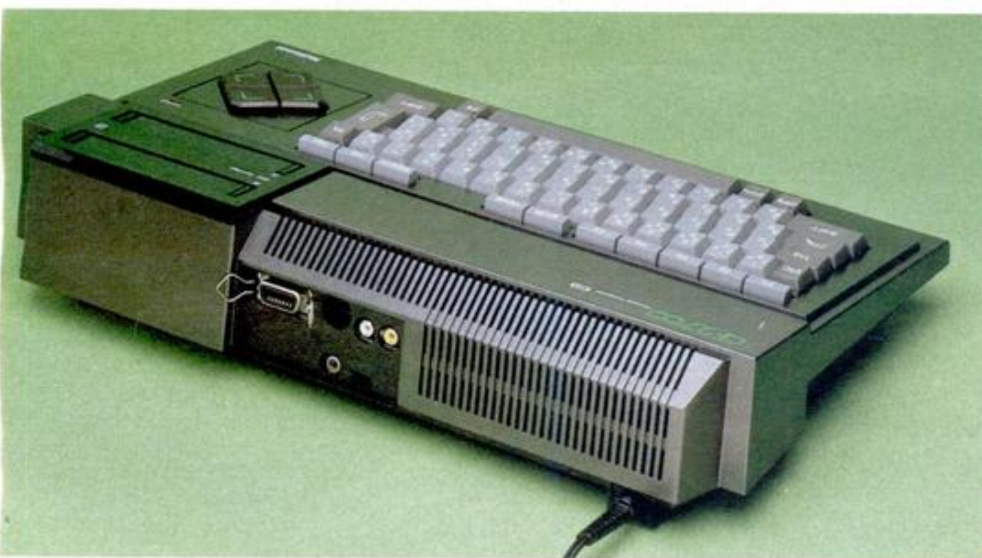
●後ろから見たショット。電源部の放熱を考え、スリットがかなり広範囲にわたって切られている。前から見たときはそれほど感じなかったのだが、この角度から見るとマシンのボリューム感をおわかりいただけるだろうか。これを、「重い」と感じるか、「安定感がある」と感じるかは人それぞれだが、1クラス上のマシンのイメージだ。
