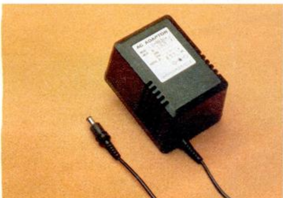
◆PV-7用のACアダプタ。コンピュータの中で一番重い電源部を外部に分けることで、本体の軽量、小型化に一役買っている。
