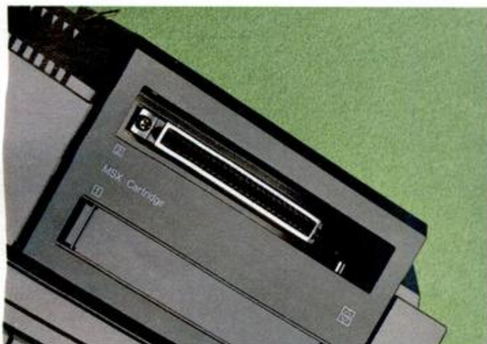
●本体右上部のスロット。コネクタ部分を金属で補強してあるのがよくわかる。スロット内部に見える突起はリセットスイッチ。
