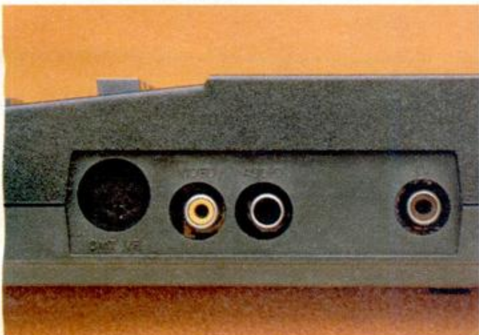
◆オプションのカセットインターフェイスを、左のCMTポートに接続する。中央が映像・音声出力、右がRF出力の端子群。
