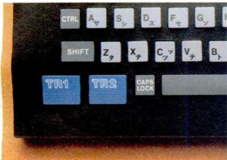
◆ゲーム専用に使われた、2つのトリガーボタン。ジョイスティック用のSTRIG 関数に対応してつくられている。
