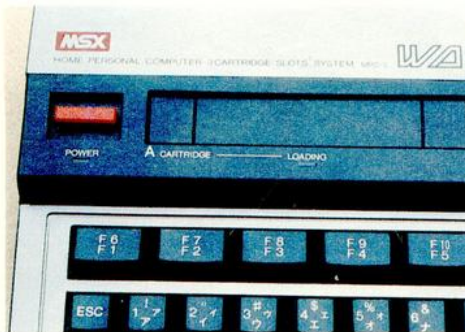
●ローディングランプが点灯して、使用可能なことを示す。
