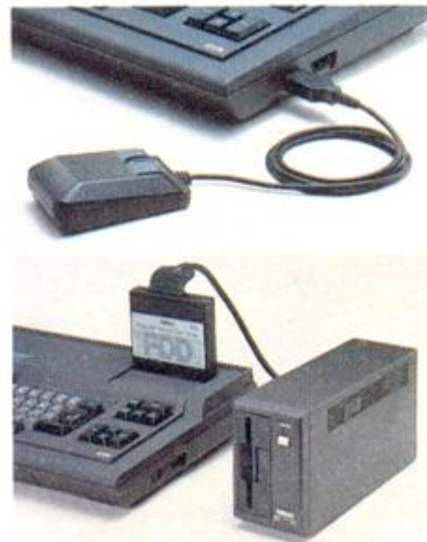
MSXマウスはCX本体右サイドの汎用I/Oポートにつなぎます。 ●MSXマウス MU-01 ¥12,800
