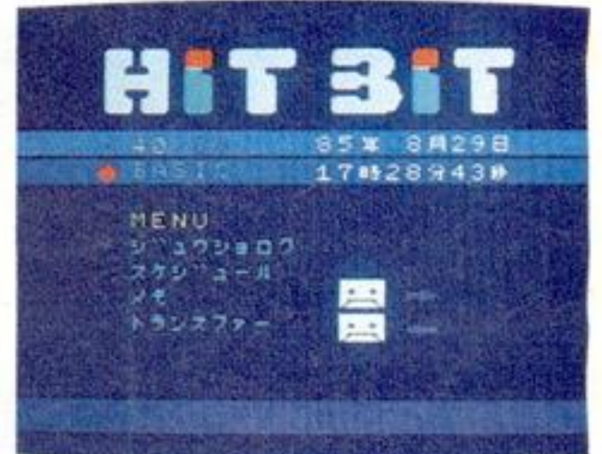
HB-F5の起動画面。バッテリーバックアップにより、現在の日時が自動的に表示されている。
