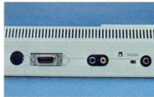
左からカセットIF、プリンタIF、コンポジット出力、RF出力。放熱のためスリットが切られている。
