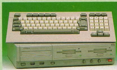
●MSXのCPUであるZ80の上位バージョン、HD-64180を搭載。最速で2.2倍の処理が可能で、速い！
