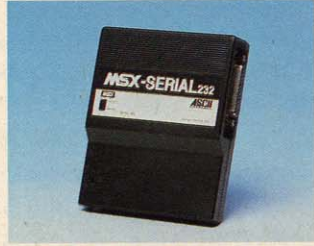
▶ 汎用モデムを使用するさいに必要な、RS-232Cインターフェースだ。
