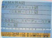
漢字ワープロユニット(SKW-01)と熱転写プリンタ(PN-01)をセットすれば、使い易く高品質印字の日本語ワープロに。第1水準漢字非漢字3564文字種を搭載。さらに任意の文字等30種類までユーザー定義。
