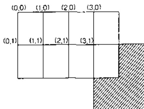
Wird die Bildgröße (BLOCK SIZE) und die Startposition (START BLOCK) kombiniert verwendet, so kann man folgende Bildeinstellung erhalten.
