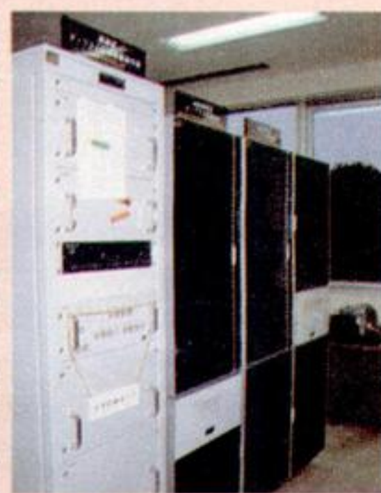
●MSSの高密度記録再生装置。インチテープに記録する。●クイックルック装置を囲んで、テレコンクラブが取材中。
