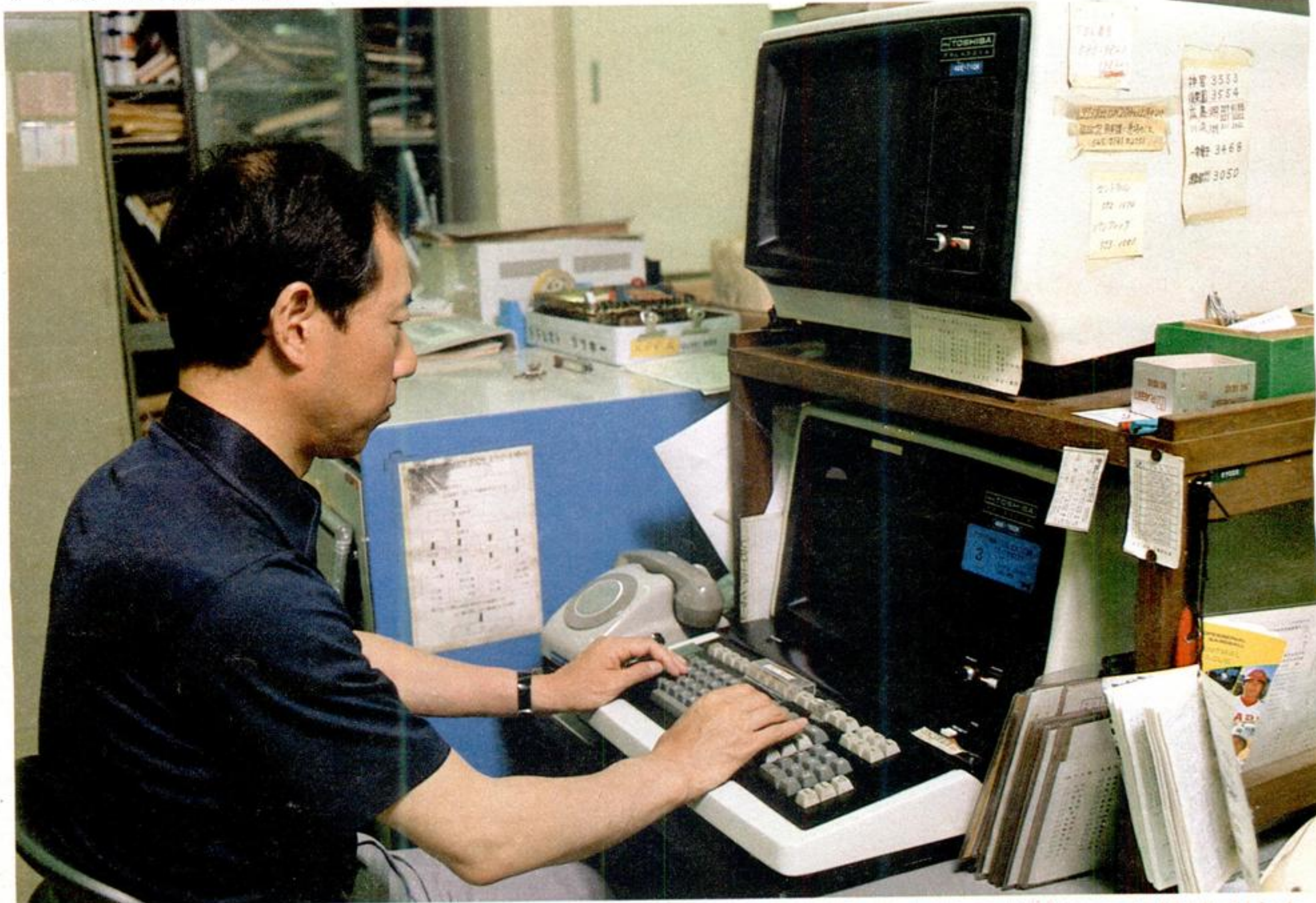
MCRでマークカードを読み取った後、東芝TOSBACで必要な情報を選別し、KPR(漢字プリンタ)で確認してから、新聞社、放送局へデータを送る。通信部の松本さんにキーボードをたたいてもらった。
