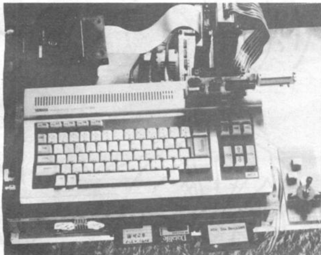
①世界に1つしかないMSXシステム。第1スロットに差し込まれているのはROM WRITER。
