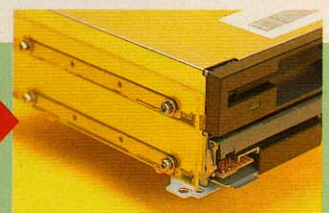
◆ふたつのドライブは板とネジ、両面テープで固定。写真ではアクリル板を使用。
