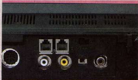
■プリンターフェイスとカセット、そしてアナログRGB出力。この左側にふたつ目のカートリッジスロットが用意されている。
