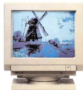
9 CM 082. VGA Pro-Line kleurenmonitor. Resolutie 640x480 beeldpunten. Schermdiameter 34 cm. Lijnfrequentie 31,5 KHz. Rasterfrequentie 60-70 Hz. Anti-reflectie (geëtst) black matrix scherm. Pitch 0,31 mm. Bandbreedte 30 MHz. Inclusief verstelbare voet en aansluitkabel.
