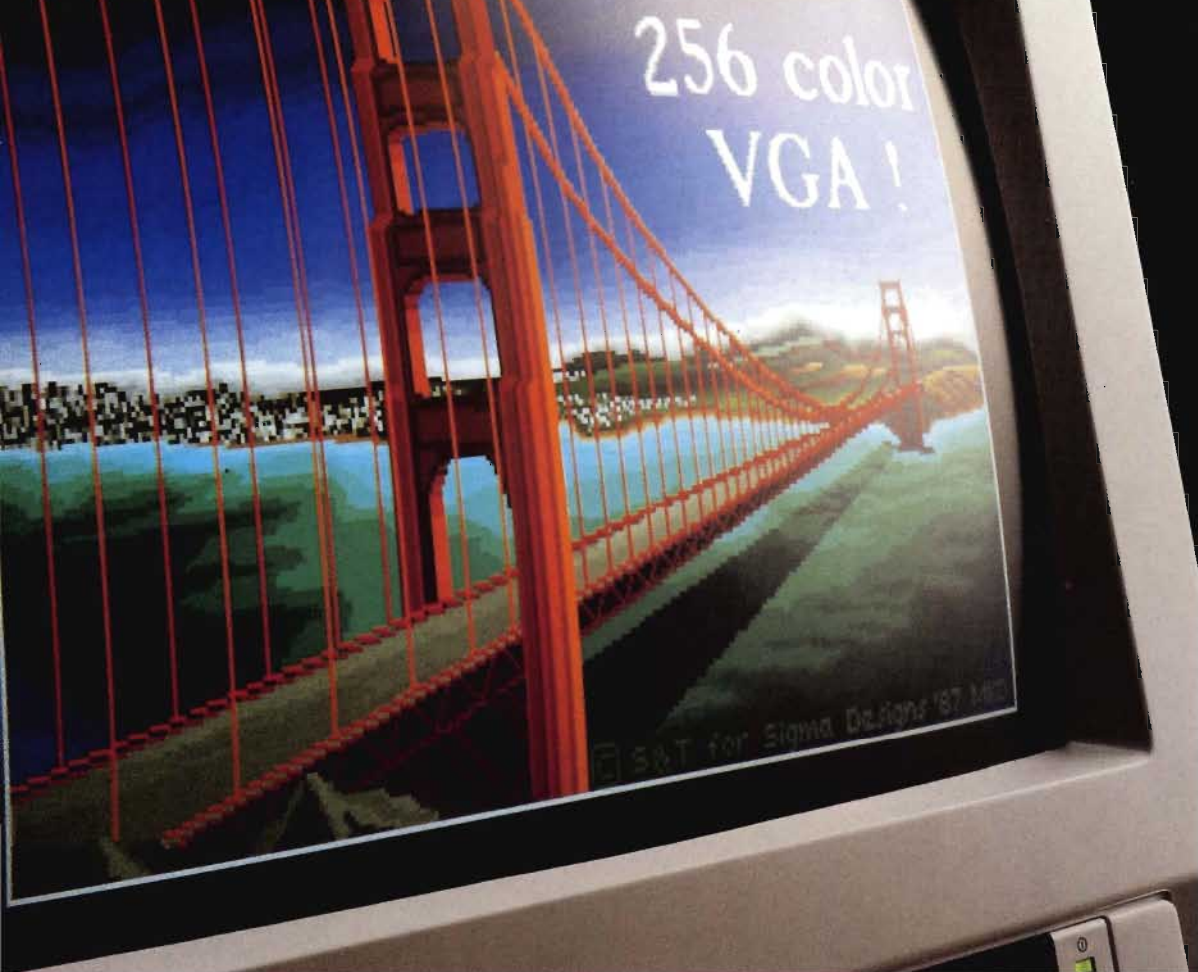
3 CM 9809. VGA Pro-Line kleurenmonitor. Resolutie 640x480 beeldpunten. Schermdiameter 34 cm. Lijnfrequentie 31,5 KHz. Rasterfrequentie 60-70 Hz. Anti-reflectie (geëtst) black matrix scherm. Pitch 0,29 mm. Bandbreedte 30 MHz. Inclusief verstelbare voet en aansluitkabel.
