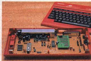
▲改造前のA1だ。まずフタをはずして、どこにZ80AとVDPがあるか確認しよう。
