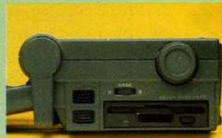
■本体右側面にあるディスクドライブ。上はプリンタの印字濃度の調整ツマミ。
