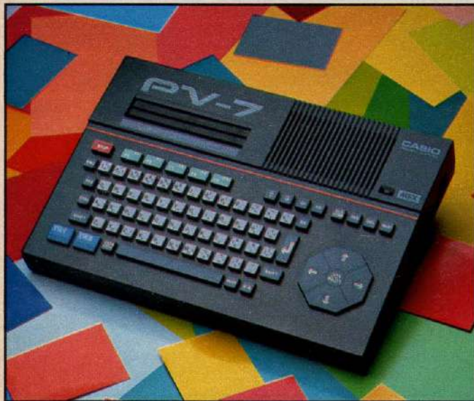
↑カシオ・PV-7。カシオのMSX第1弾。RAMは8KB。コスト低減を狙った。
