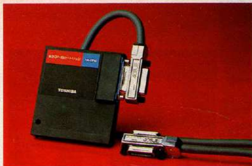
◆東芝から発売されたGP-1Bカートリッジ「HX-GPIQ」。IEEE-488準拠のインターフェイスで、各計測機とMSXを接続する。
