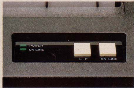
↑LFは紙送り、ON LINEで印字可能になる。→セントロニクス社仕様準拠のプリンタインターフェイス。本体後面にレイアウト。
