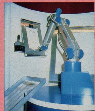
▲テーマ館のロボットは、早稲田大学加藤研究室。1秒間に15回という速さで鍵盤を打つ。バッハからビートルズまで、指示された曲を演奏。
