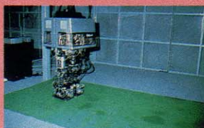
▲人間の腰から下の部分だけのロボットが人間の歩行を模して歩き、4本足ロボットはクモそっくりに足を動かし、ソロリ、ソロリと歩く。
