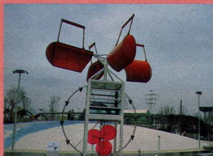
▲水車風車／風の力で回転する風車の回転によって湯水ホイールを回し、タンクに水を汲みあげる。タンクの水は一定量になると流れ出し、もう1つのホイールを回す。
