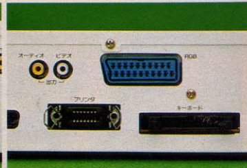
◆MSX2には欠かせない、アナログRGB21ピン出力端子。下にあるのはキーボードのコネクタだ。
