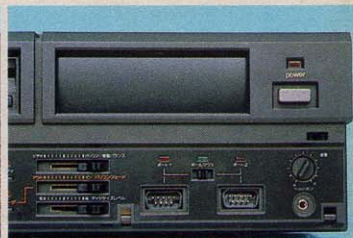
◆ボールマウスはジョイスティックポートを兼用している。場合に応じてポート1と2を使い分ける。
