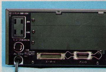
◆かくし蓋を取ると、拡張ボードを接続するコネクタが並んでいる。ヒューズが付いたMSXも珍しい。
