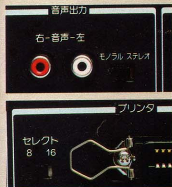
④ステレオになっている音声出力⑤画面コピーのためのプリンタのドット数セレクト
