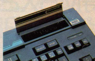
▶後面に配置された第2スロット。使用頻度の少ないものをどうぞ。
