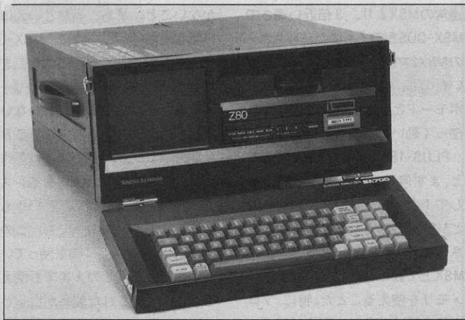
▲SA700-Z80の画面写真。ICE本体にモニターが付属しているから、MSXの画面を乱すことなくデバッグができるというわけだ。
