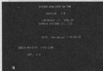
▲SA700-Z80の画面写真。ICE本体にモニターが付属しているから、MSXの画面を乱すことなくデバッグができるというわけだ。
