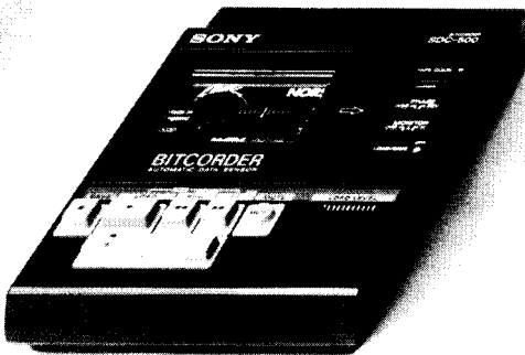
SDC-500, datarecorder. Voor opslag van gegevens op audio/computercassettes. Start/stop door computer, met 'n speciale lichtnetvoeding (extra).
