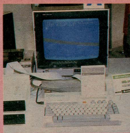
↑MSXフルシステム。縦長のカートリッジがフロッピーディスクインターフェイスで、2台までコントロール可能。ディスクは3インチ。
