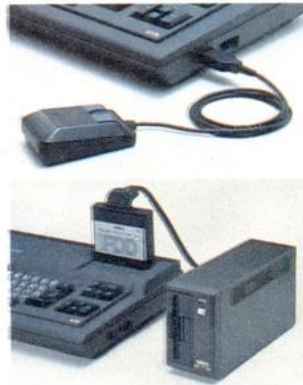
MSXマウスはCX本体右サイドの汎用I/Oポートにつなぎます。
