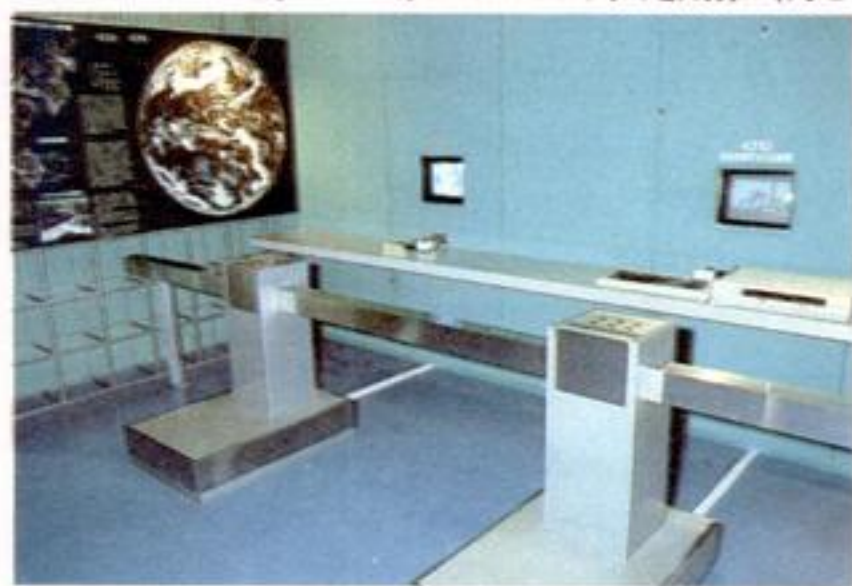
◆◆気象衛星ひまわりの画像受信システム。右の写真の手前にあるコントローラーを使い、見たい地域にズームしたり、画面をスクロールさせたりが可能。
