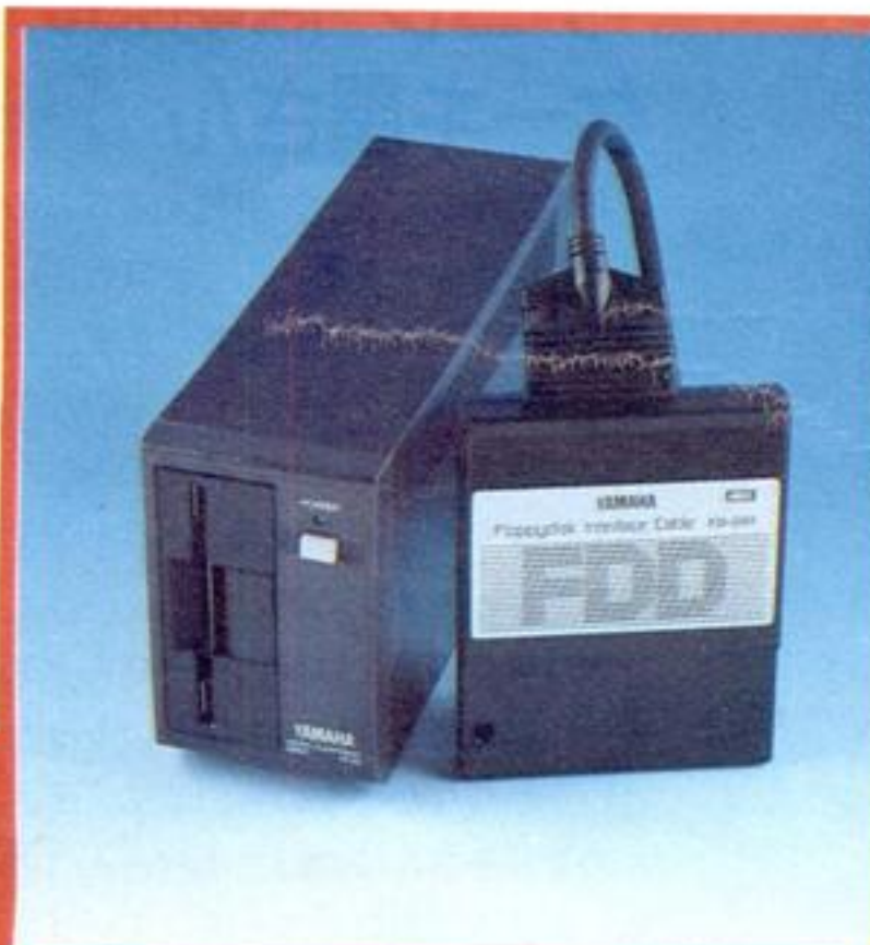
YAMAHAのFD-05は2DDのドライブ。このディスクドライブは、すべてのディスクに対応できる。
