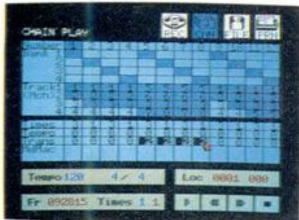
チェーンモード：シーケンスごとにバンク、リピート、テンポチェンジなどを指定します。
