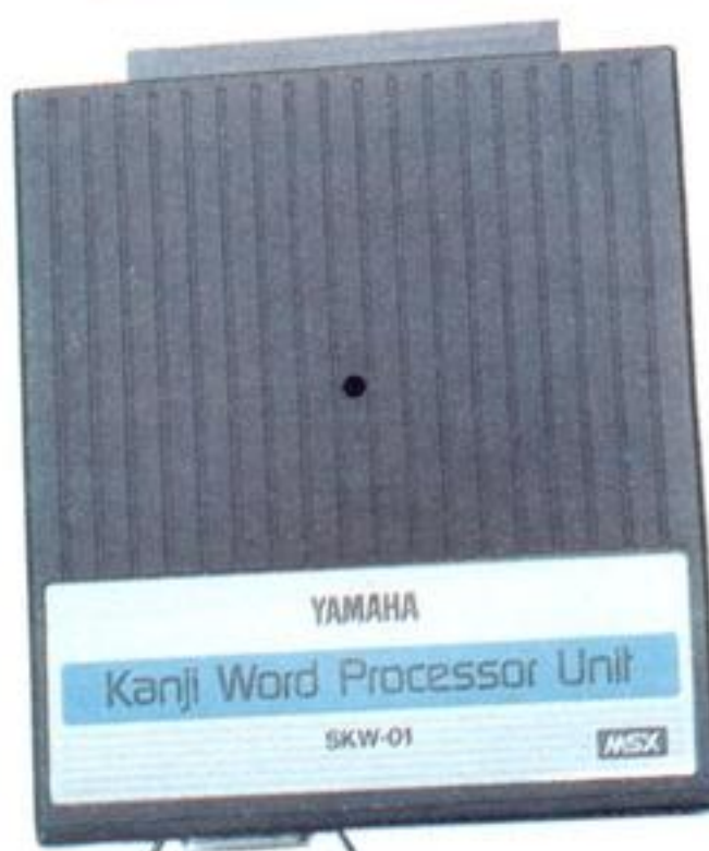
ヤマハ 漢字ワープロユニット SKW-01。プリンター・インターフェイスを内蔵しているため、プリンター・インターフェイスのないMSXにも使用可能。ヤマハ以外のMSXにはユニットコネクタUCN-01を介してカートリッジスロットに接続。
