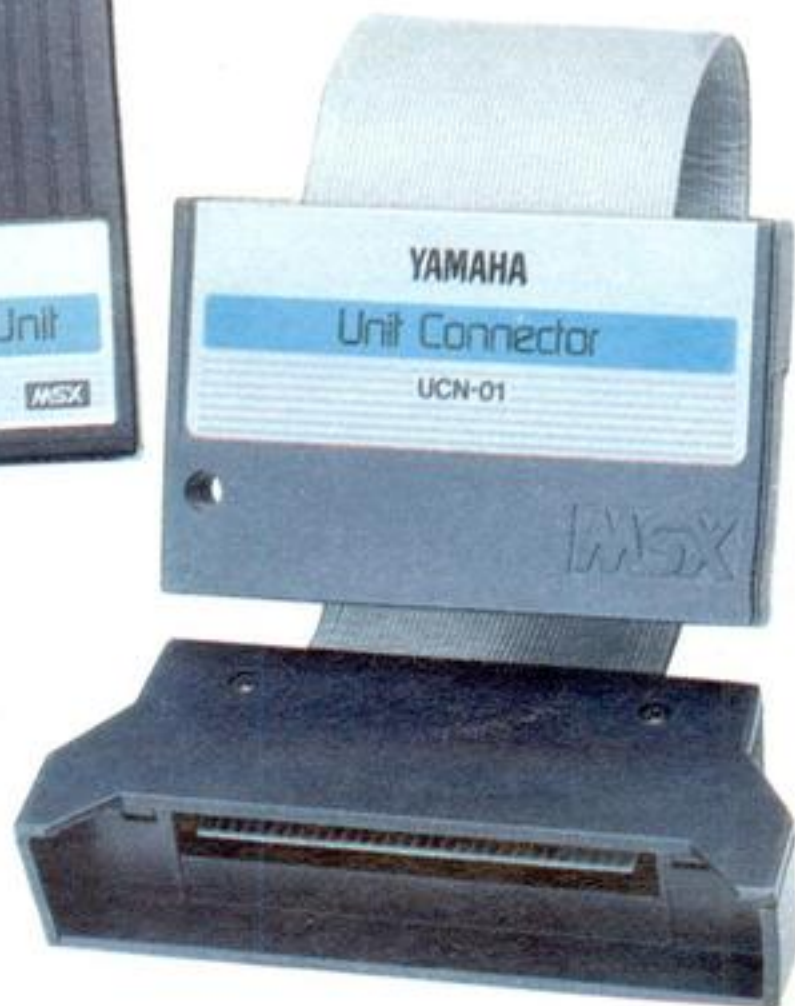
ヤマハ 漢字ワープロユニット SKW-01。プリンター・インターフェイスを内蔵しているため、プリンター・インターフェイスのないMSXにも使用可能。ヤマハ以外のMSXにはユニットコネクタUCN-01を介してカートリッジスロットに接続。
