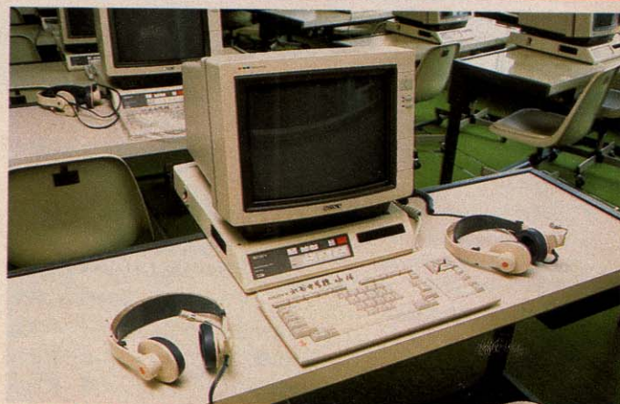
◆生徒側の学習ターミナル。キーボード2台で個別学習ができるが、北谷中学では1台のキーボードを2人で使って、協力し合いながら学習する方針を採用。モニタ下部のエデュケーションユニットを操作して先生に質問したり、答えたりできるようになっている。
