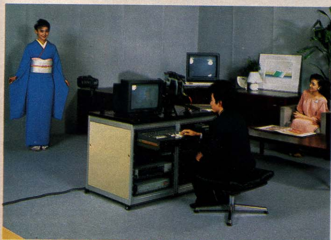
■ブルー無地の着物を着装し、銀無地の帯を締めた顧客本人の姿をカメラで撮影し、画像合成により着物の柄を重ね、好みに合うかどうかをモニタ画面で確認する。
