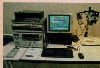
◆ソニーHB-F900とビデオユニットを中心とした開発システム。
