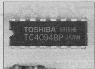
◆今回使用したCMOS-IC。比較的手に入りやすく、安価なものばかりです。
