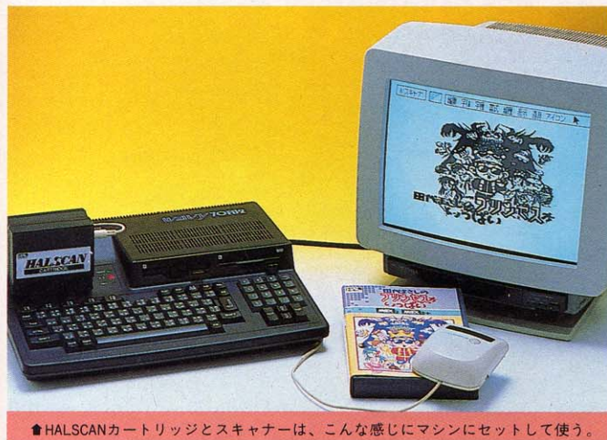
●HALSCANカートリッジとスキャナーは、こんな感じにマシンにセットして使う。
