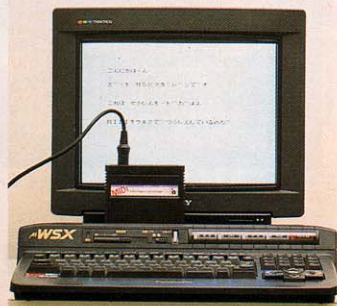
■まずMIDIサウルスをふたつ用意し、"OUT1"と"IN"をケーブルでつなぐ。MSXに差してBASICのモードになったら、下のプログラムを実行させてみよう。
