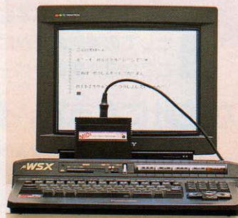
■まずMIDIサウルスをふたつ用意し、"OUT1"と"IN"をケーブルでつなぐ。MSXに差してBASICのモードになったら、下のプログラムを実行させてみよう。
