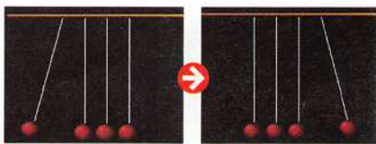
④左の球がぶつくと、間の2個は動かず右端の球が動く
